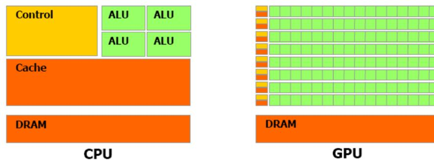
图 1-2. GPU 将更多晶体管用于数据处理
